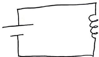
● Ao ligar o circuito, a corrente irá aumentar gradativamente até se estabilizar, assumindo um valor fixo, o que nos leva em primeira instância em uma corrente que varia no tempo;  $I = I(t)$ . Devida a essa corrente variável, um campo magnético variável surge na bobina.
